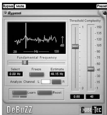
Abb. 13.27 De-Buzzer zum Entfernen von Brumm- und Dimmer-Störungen
