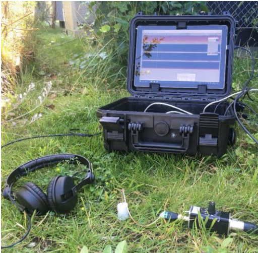
Abb. 6. Mobiles Aufnahmegerät mit Vorverstärker und Eigenbau akustischer Sensor.
