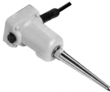
Abbildung 5.4: Geofon (Empfindlichkeit 26 V/(m/s), Frequenzbereich von 1,6 Hz bis 300 Hz)
